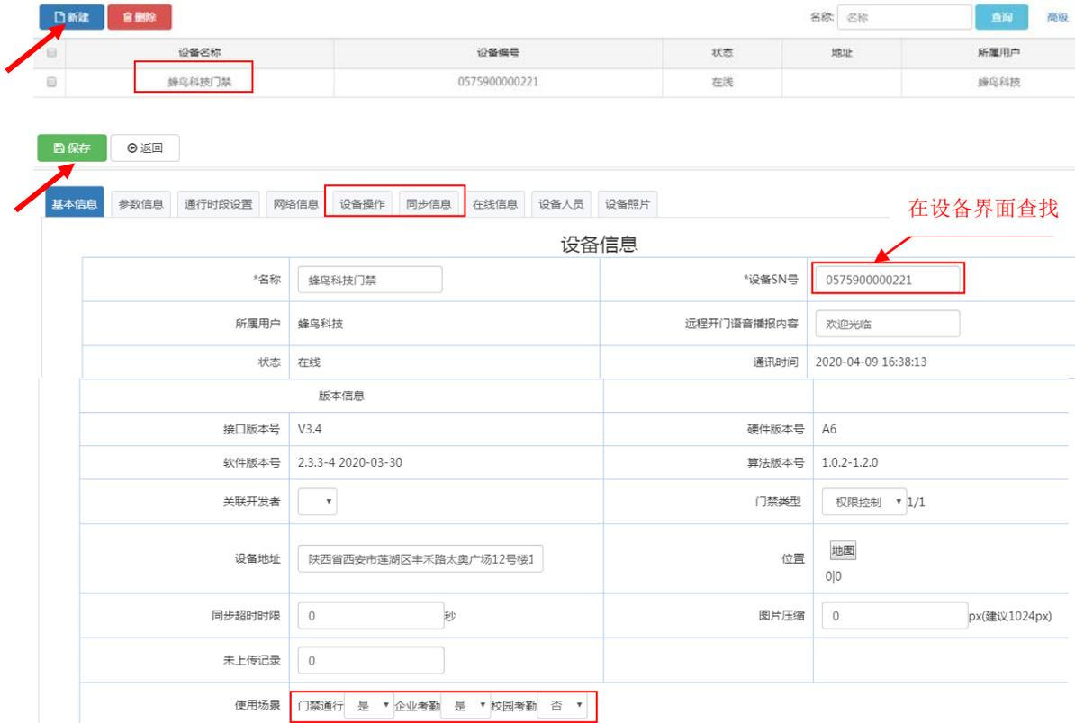
**1.2 参数信息：**点击【参数信息】，设置各参数信息，然后点击【保存】，需要同步到设备点击“设备操作”页面下的【设备参数】，然后在“同步信息”页面中查看同步状态，如下图所示：
