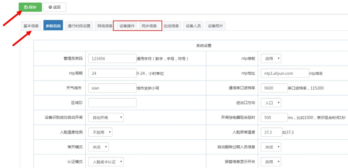
**1.3 通行时段设置:** 点击【通行时段设置】, 设置可通行日期、周一到周日的自定义时段, 然后点击【保存】, 需要同步到设备点击“设备操作”页面下的【设备参数】, 然后在“同步信息”页面中查看同步状态, 如下图所示:
