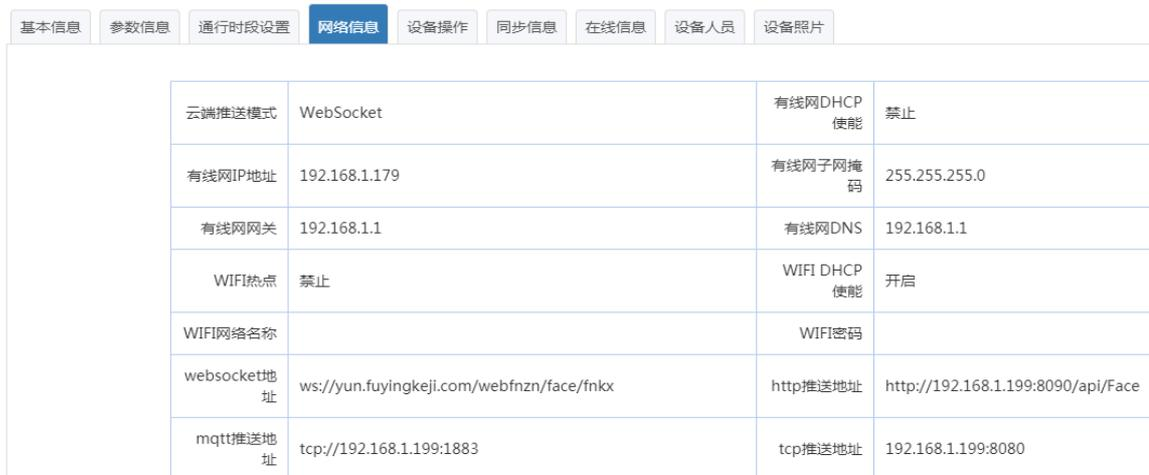
**1.5 设备操作:** 所有参数设置好后, 点击【设备操作】页面中的【设置参数】, 即可将设置的参数同步到设备, 如下图所示:
